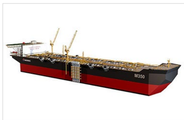
次世代 FPSO 用新造船体「M350」
