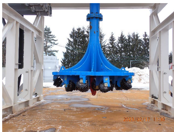
掘削ドリル全容
