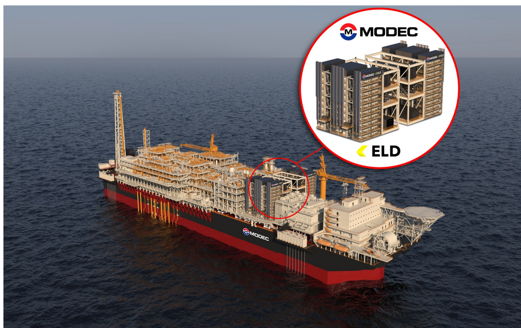
100 MW SOFC+CO 2 回収設備 統合システムを搭載した FPSO (イメージ)
