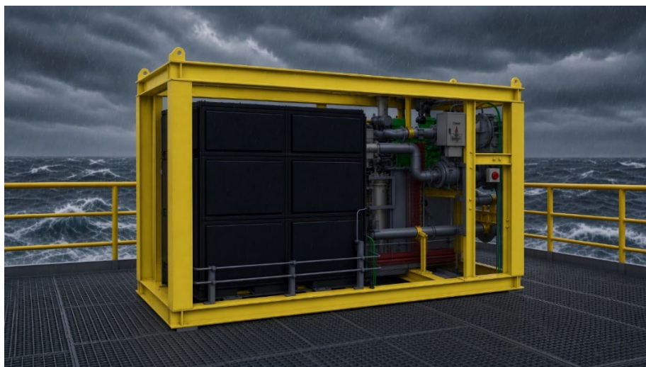
FPSO に搭載された SOFC 40kW pilot skid (イメージ)
